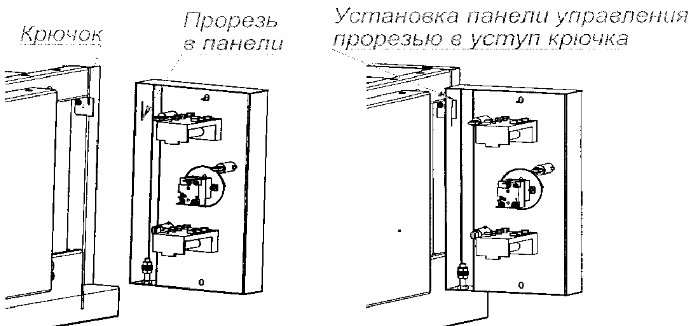
Рис. 8 Схема установки панели управления при ТО
