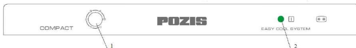
Рис.2 Регулировка температурного режима 1 – ручка терморегулятора; 2 – индикаторная лампа (сеть) ;
