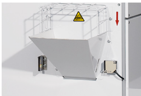
Sensore all'ingresso per evitare entrate doppie Sensor at the entrance in order to avoid double piece entry Capteur à l'entrée pour éviter entrées doubles Sensor a la entrada para evitar entradas dobles
