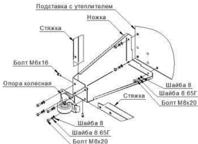
Рис. 4 - Схема сборки подставки
