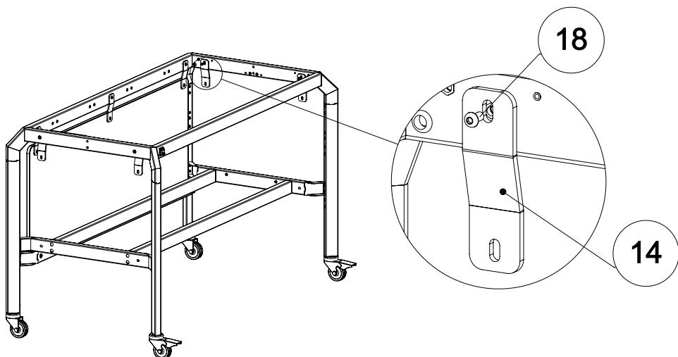
**9.** Установите боковины (4) к пластине (14) винтами M6 x 16 (18), к опоре винтами M6 x 40 (17) через шайбу(21).
