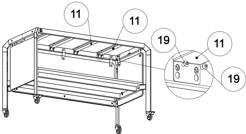
**12.** Закрепите уголки (15) к столешнице (1) винтами M6 x 12 (19). После закрепите столешницу (1) винтами M6 x 12 (19).
