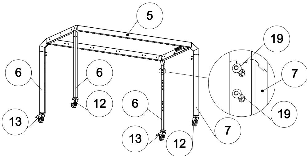
**3.** Закрепите опору длинную (8) винтами M6 x 12 (19).
