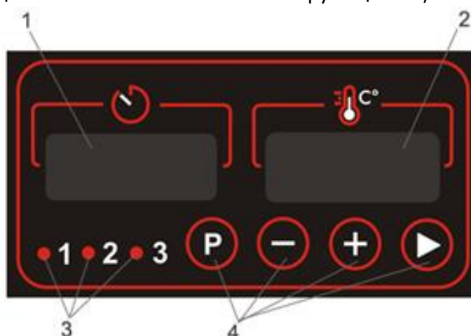
Рис.2. Панель управления пицца-печью
