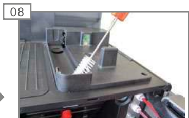
08 Удалите остатки порошка с помощью щетки.
