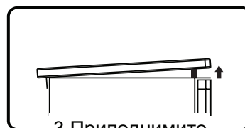
3. Приподнимите верхнюю крышку спереди и установите упор.
