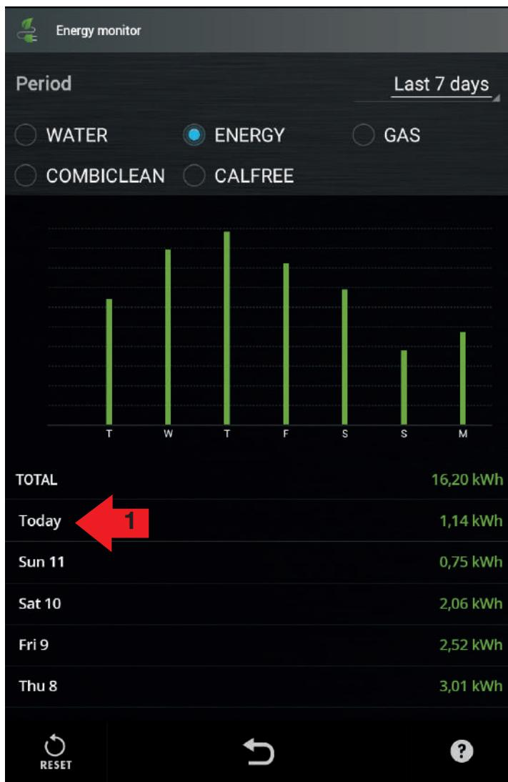
**Energy Monitor** позволяет отображать информацию, касающуюся расходов печи в определенный период.
