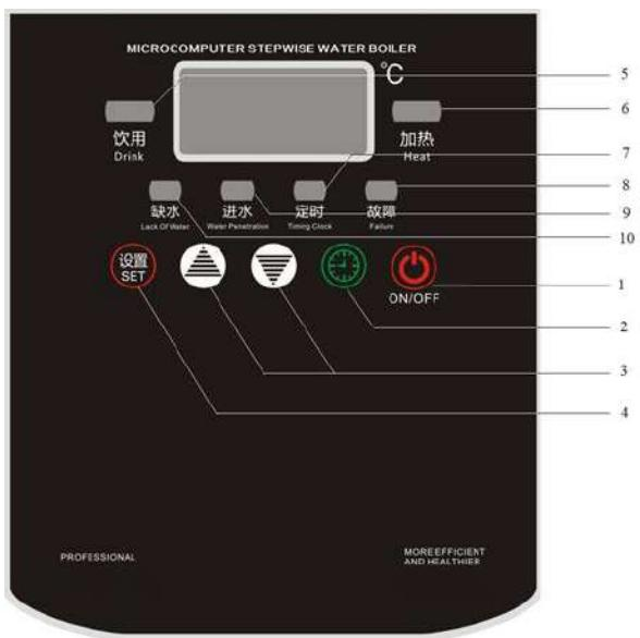
1-кнопка включения/выключения питания; 2-кнопка установки времени; 3-кнопки увеличения/уменьшения значений выбранных параметров; 4-кнопка выбора/установки параметров; 5-индикатор достижения заданной температуры (вода пригодна для использования); 6-индикатор нагрева; 7-индикатор установки времени; 8-индикатор ошибки; 9-индикатор подачи воды; 10-индикатор малого количества воды.
