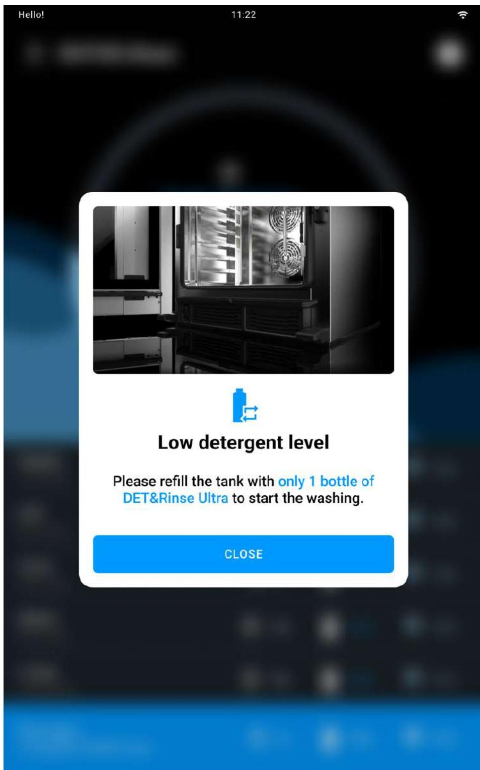
Следует заполнять бачок только флаконами емкостью 1 лitr моющего средства Det&Rinse™ Ultra UNOX, которое является единственным утвержденным и тестированным средством для мойки рабочей камеры.
