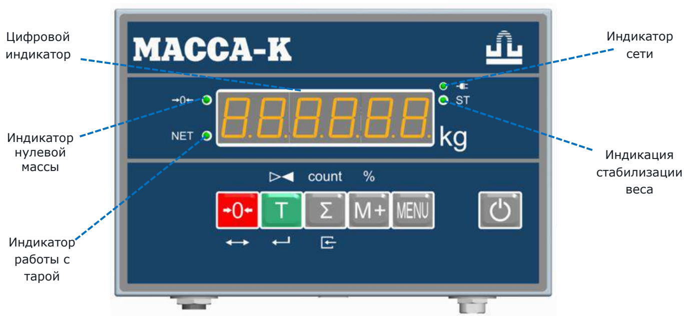
Передняя панель терминалов АВ и АВ(RUEW)
