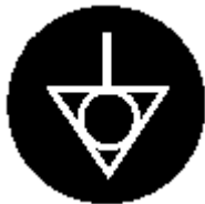
ЗАЗЕМЛЕНИЕ НА КОНТУРЕ ПИТАНИЯ
